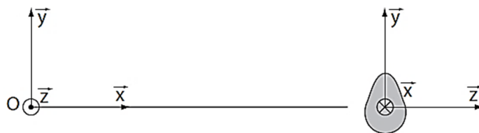
Figure 4. Disposition répondue du repère par rapport à la ligne moyenne.
